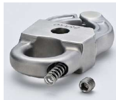
経年劣化などにより、スプリングの性能が十分でなくなったときはトップにあるねじを六角レンチで取り外しスプリングの交換ができます。
