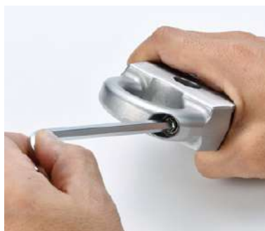
経年劣化などにより、スプリングの性能が十分でなくなったときはトップにあるねじを六角レンチで取り外しスプリングの交換ができます。
