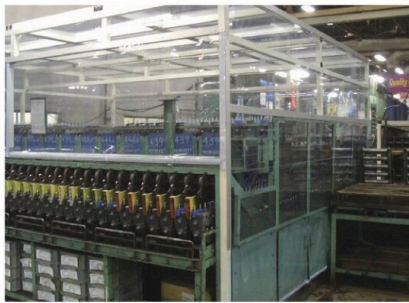
ビニールブース (スチールフレーム)
