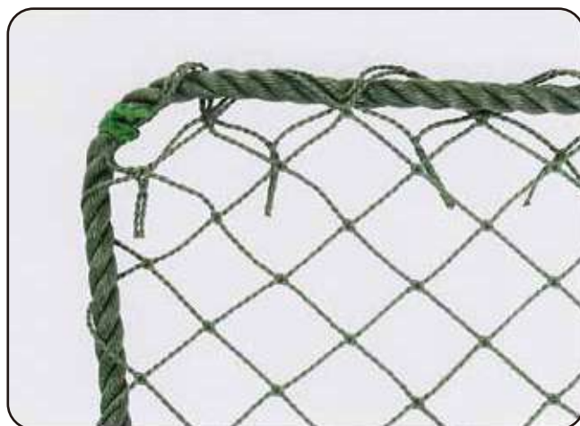
落石防止ネット 周囲ロープ通し加工 四隅固定
