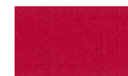
9120F 紅色 透光率 3.4% 紫外線遮蔽率 100.0% マンセル値 色相(H)2.27R 明度(V)3.81 彩度(C)11.86
