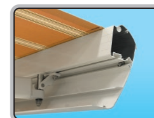
■ボックス前枠2ピースジョイント【特許出願済】 2ピース構造の採用により、前枠の下半分が後付けでき、施工時のアーム調整が容易になりました。
