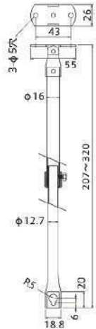
大型伸縮吊棒寸法図 (mm)
